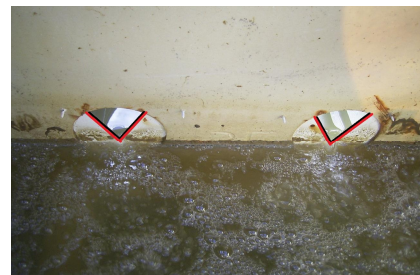
写真 4 V ノッチ設置
